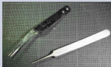
Pince souple (fine), à gauche et pince Dumont n°5, à droite - Cliché A. Fraval.
