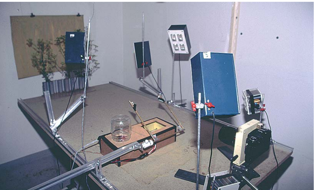
De cette boîte, les Orthoptères ne peuvent sortir que par la fenêtre, barrée de faisceaux infrarouges. Pour donner aux insectes un maximum d'activité, je réchauffe à 30°C l'intérieur de la boîte à l'aide d'une résistance placée dans un double fond.
